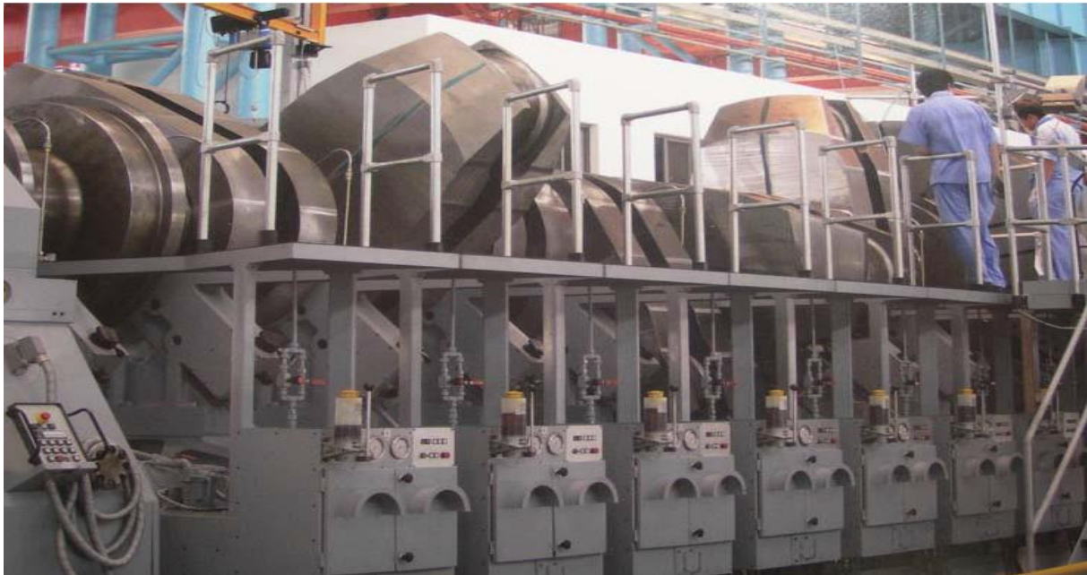
Obr. 16. - Klikový hřídel podepřený pulzačními opěrami
