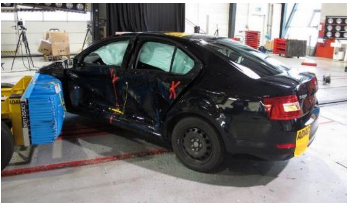
Obrázek 56: Euro-NCAP – boční náraz – skutečný test [3]
