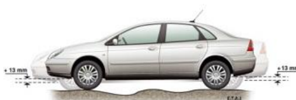
Obrázek 11: Nastavitelný podvozek Hydractive 3 značky Citroën [27]
