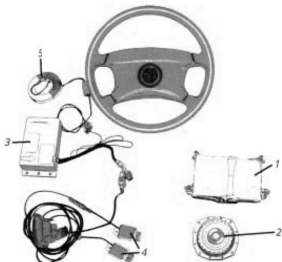
Obrázek 44: komponenty systému s airbagem [10]
