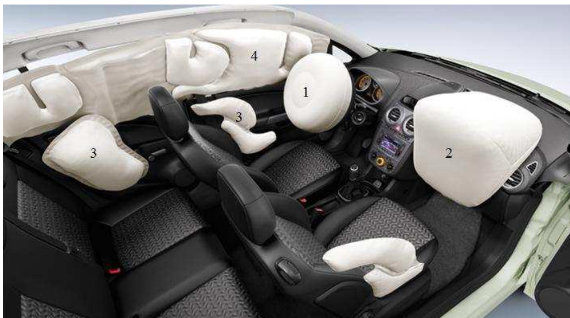
Obrázek 42: 1 – airbag řidiče, 2 – airbag spolujezdce, 3 – boční airbagy, 4 – hlavový airbag [1]
