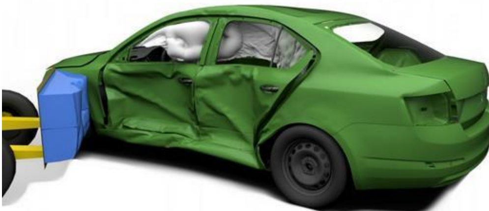
Obrázek 55: Euro-NCAP - boční náraz - PC simulace [3]
