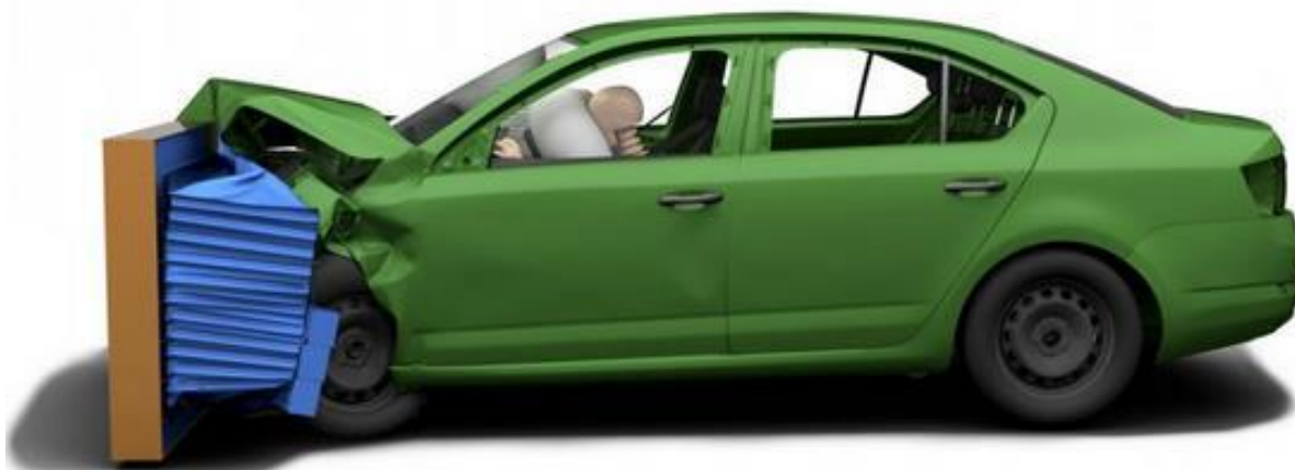
Obrázek 52: Škoda Rapid - počítačová simulace testu [3]
