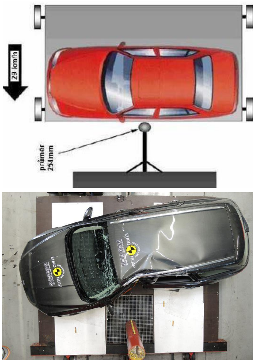
Obrázek 57: Euro-NCAP - boční náraz na sloup [36]
