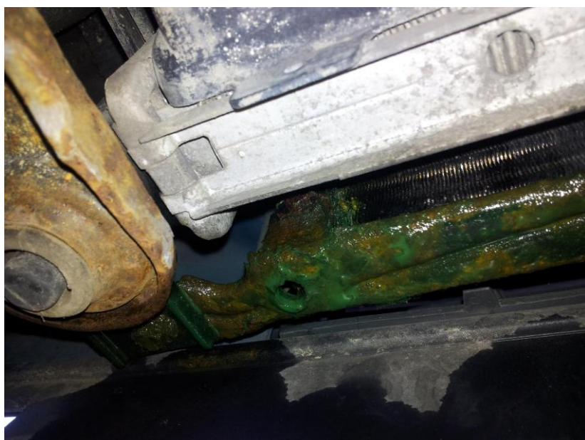
Obr.4-8 Zkorodovaný kondenzátor klimatizace [29]
