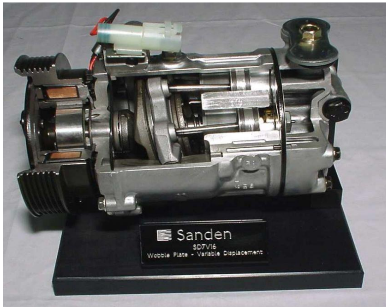
Obr.3-1 Pístový kompresor klimatizace s kývavým kotoučem [9]
