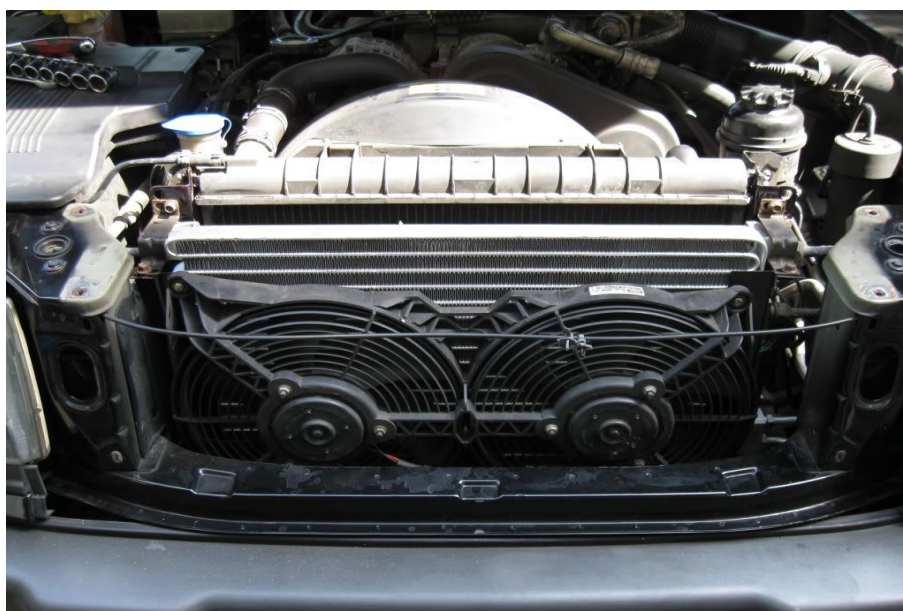
Obr.3-6 Umístění kondenzátoru ve voze Land Rover [1]
