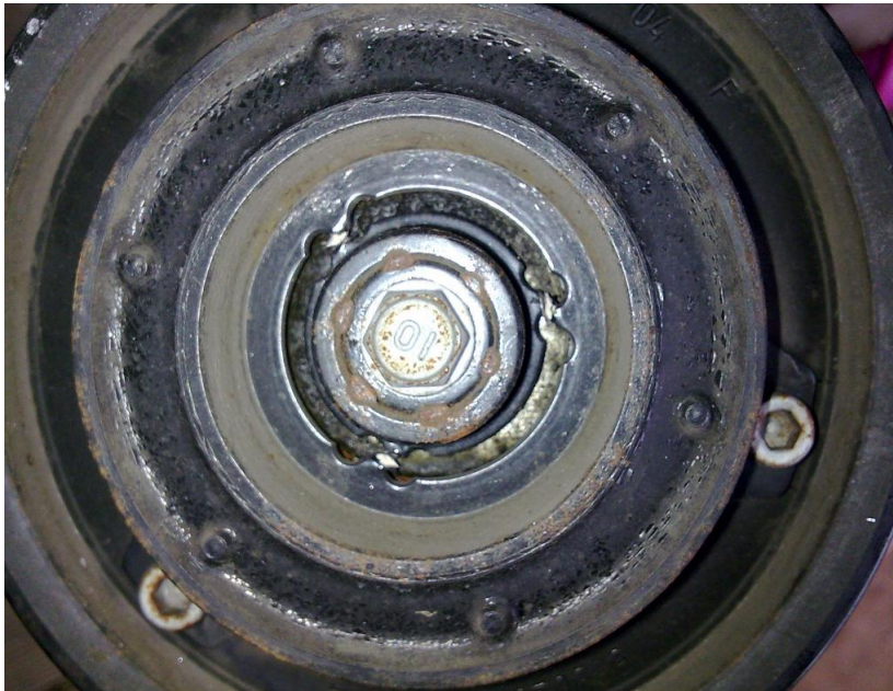
Obr.4-4 Přestřižená bezpečnostní spojka kompresoru [27]
