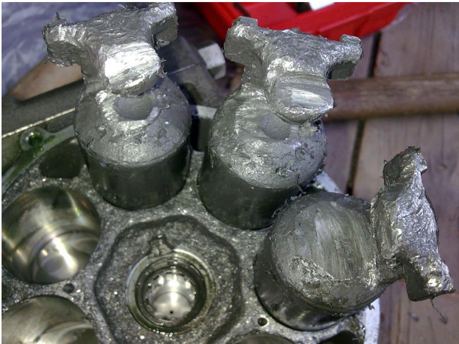
Obr.4-3 Poškozený kompresor klimatizace z vozidla Škoda Octavia [27]
