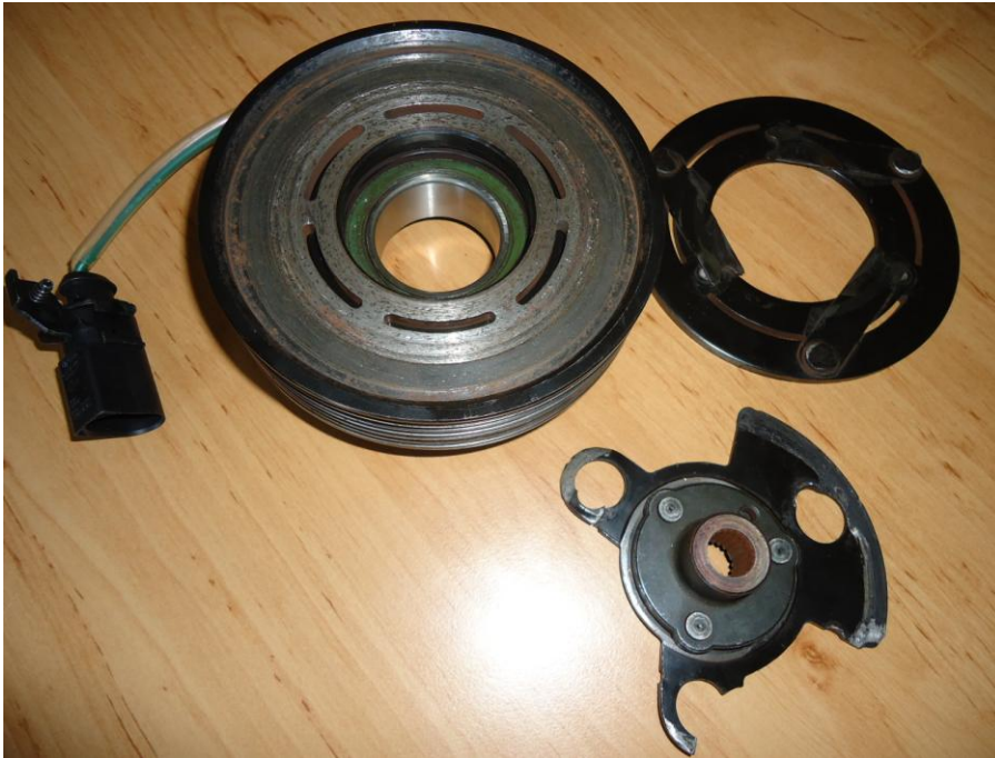
Obr.4-5 Poškozený přítlačný talíř elektromagnetické spojky
