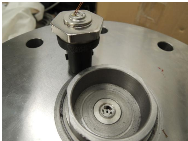
Obr. 32 Výsledek montáže bez mazání senzoru
