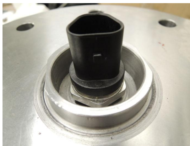
Obr. 30 Krok 4 - vložení senzoru Bosch DS M1 TF CNG
