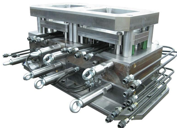
Obrázek 11 - Tlaková lící forma [22]
