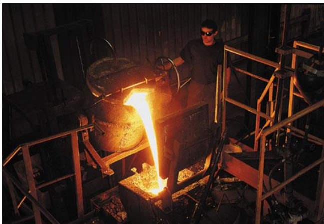
Obrázek 2 Gravitační lití kovu[13]
