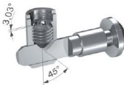
Obrázek 11 - Sestava spojovacích prvků "Verbinder - Einzelteile" [11]
