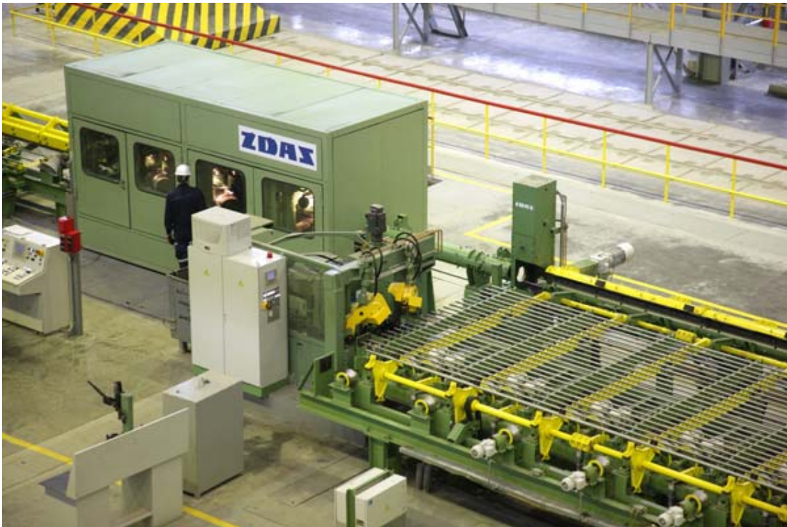
Obrázek 4 - Linka na úpravu tyčí v rozsahu \varnothing 18 - \varnothing 95 [5]
