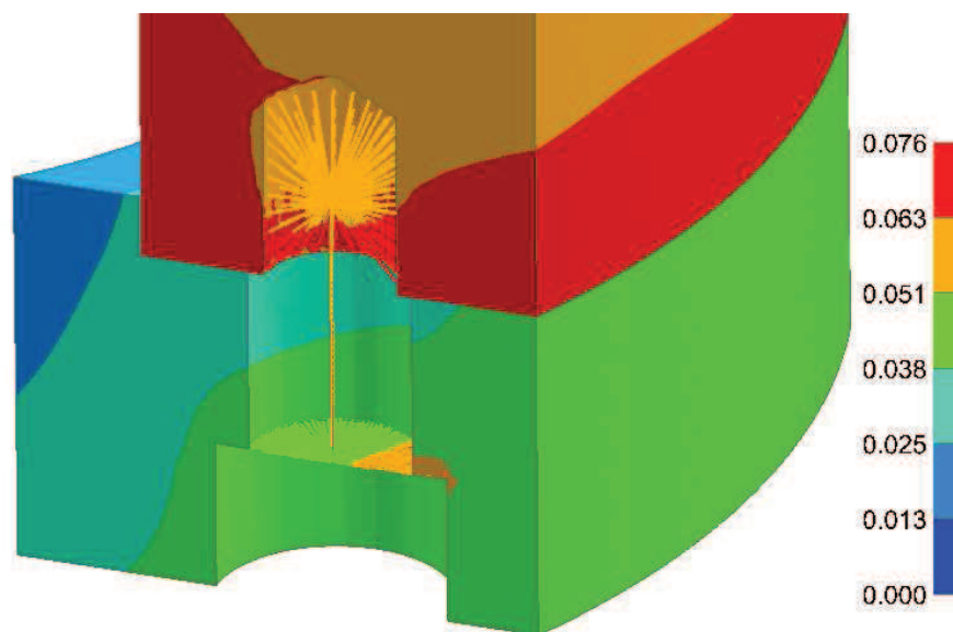
Obr. 48 Deformace šroubu M48
