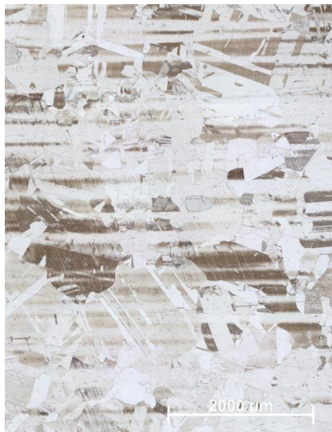
Obr. 34 Mikrostruktura materiálu 16H
