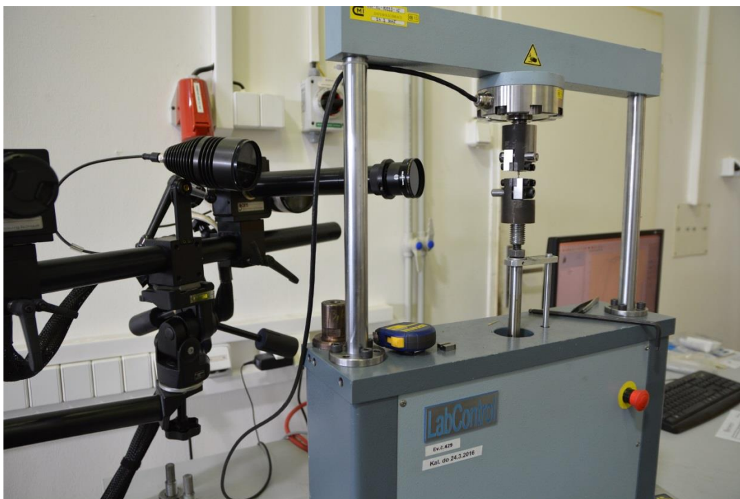
Obr. 16 Zkušební stroj LabControl s měřícím zařízením ARAMIS
