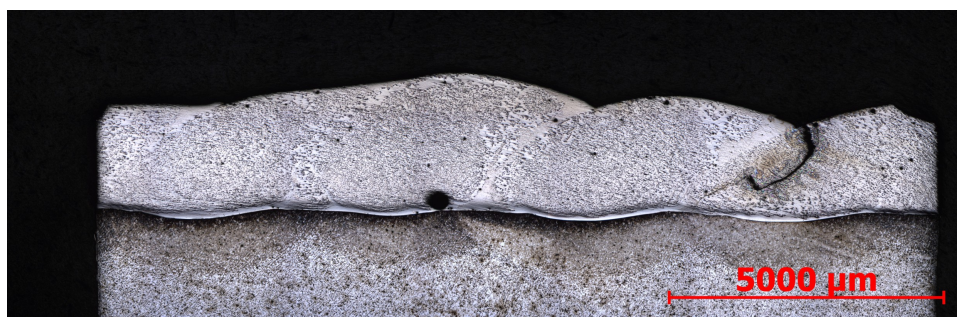
Obr. 3.4.5 Předehřev 220 °C, leptadlo Adler, velká prasklina, zvětšení 25x
