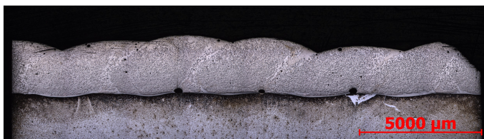
Obr. 3.4.5 Předehřev 220 °C, leptadlo Adler, velká prasklina, zvětšení 25x
