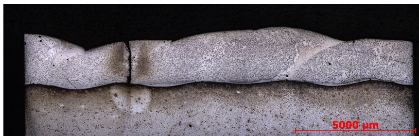
Obr. 3.4.3 Předehřev 120 °C, leptadlo Adler, vleká prasklina, zvětšení 25x
