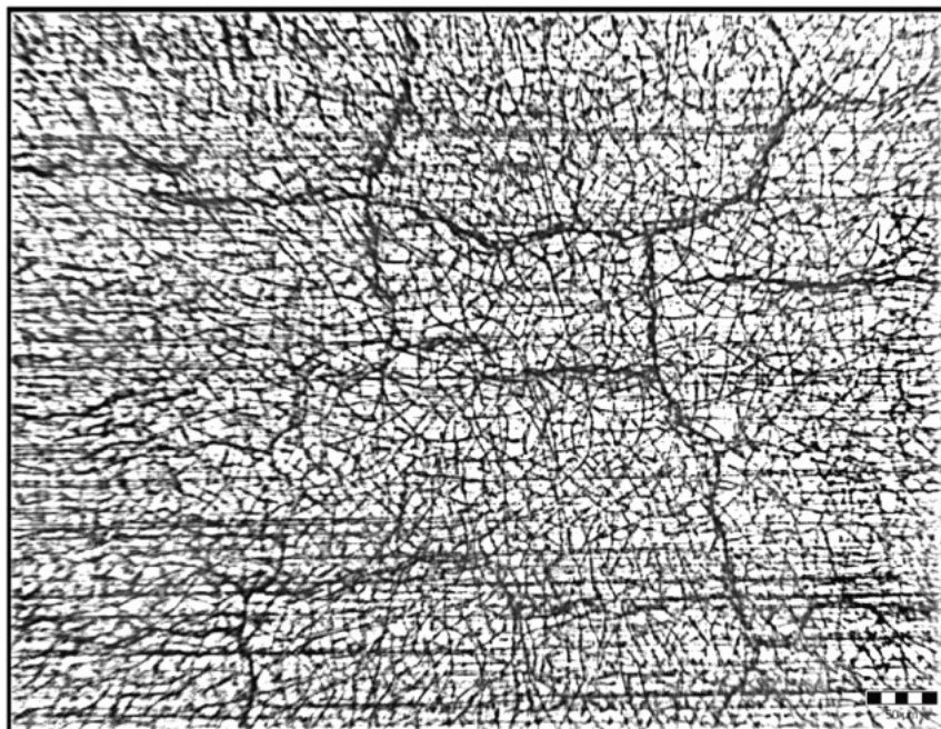
Obr. 1.3.2 Síťové povrchových trhlin chromového povlaku [6]
