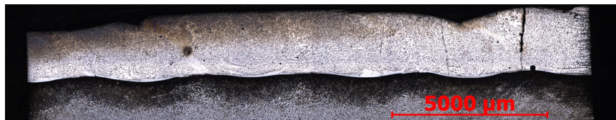
Obr. 3.4.1 Předehřev 20 °C, leptadlo Adler, zvětšení 25x
