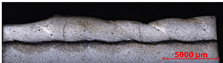
Obr. 3.4.2 Předehřev 70 °C, leptadlo Adler, zvětšení 25x
