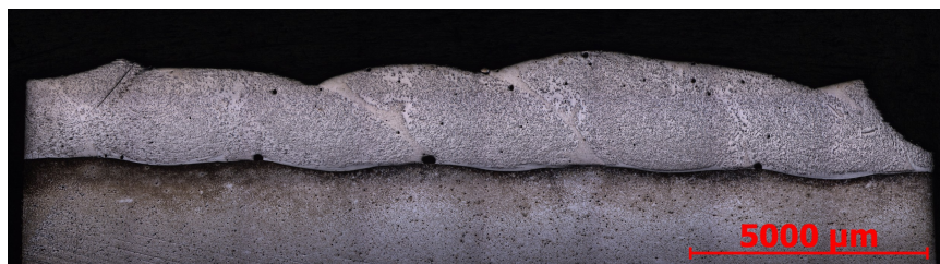
Obr. 3.4.4 Předehřev 170 °C, leptadlo Adler, zvětšení 25x
