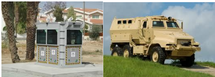
Obr. 16 – využití oceli typu Armox. [14], [15]
