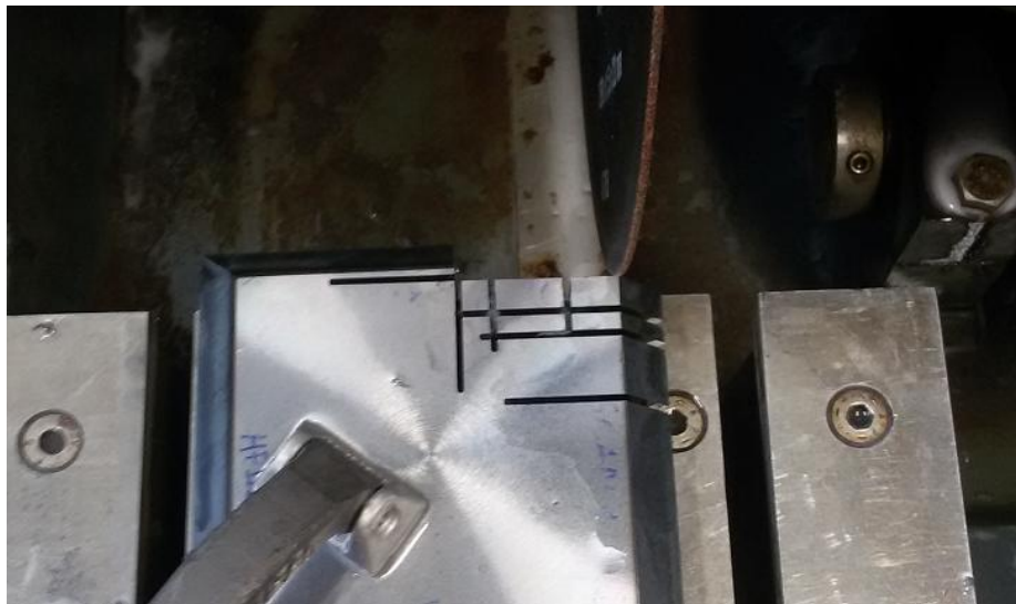
Obrázek 27 - Ukázka dělení vzorku na kotoučové pile
