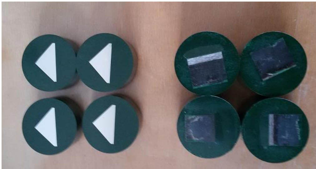
Obrázek 28 - Zalité a vyleštěné vzorky připravené pro vyhodnocení
