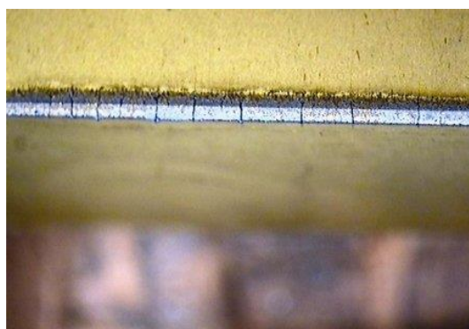
Obrázek 4.8: Hřebenové trhliny – důsledkem kolísavého tepelného zatížení při přerušovaném řezu. [24]
