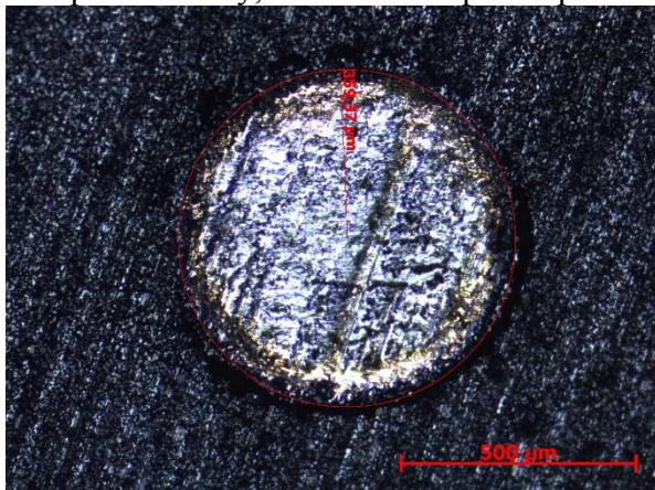
Obrázek 8.28: Broušený vzorek, TiCN 2 - 3 \mu m, 100000 dynamických N. Zvětšeno 100x (vlevo), zvětšeno 500x (vpravo).
