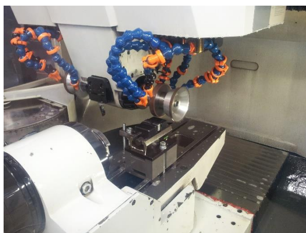
Obrázek 6.3: Způsob broušení plochy 2
