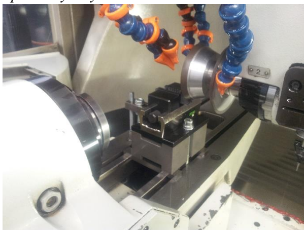
Obrázek 6.2: Způsob broušení plochy 1.
