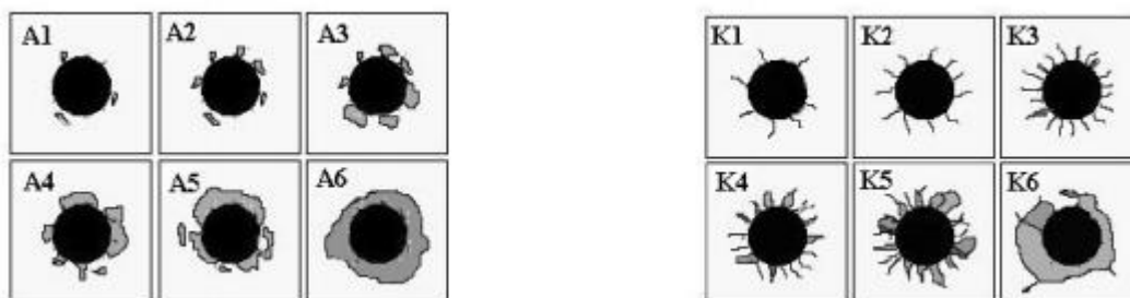
Obrázek 8.10: Hodnocení porušení okolí vtisku vytvořeného Rockwellovým indentorem při zatížení 1500N. [25]
