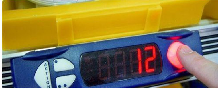
Obrázek 4-4 - světelný systém u metody Pick by Light Zdroj: [14]
