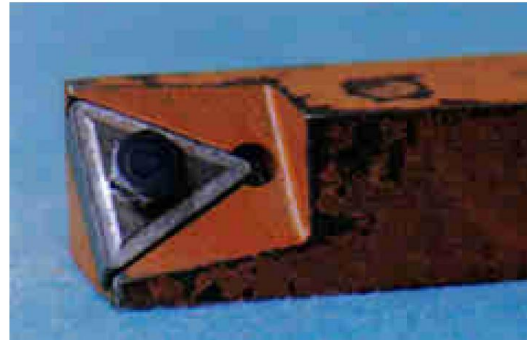
Obr. 1-9 nástroj s lineární řeznou hranou [4]
