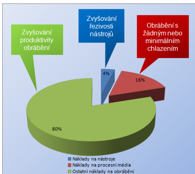
Obr. 1 Rozložení nákladů obrábění [15]
