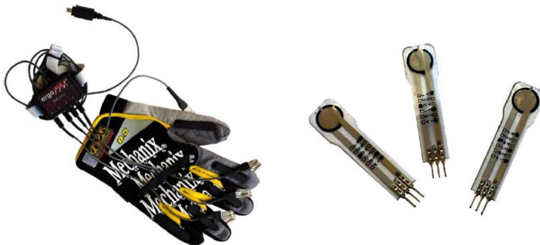
Obr. 5-2 Tenzometrická rukavice (ErgoPAK Glove) a detail FSR senzorů
