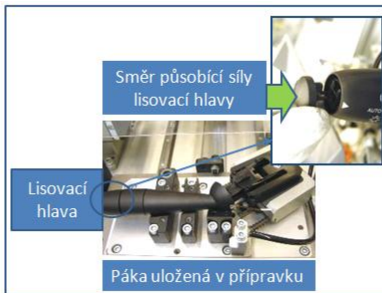
Obr. 9-3 Vizualizace návrhu automatizace lisování
