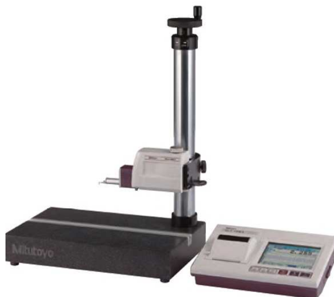
Obr. 2.15: Drsnoměr Mitutoyo Surftest SJ - 400 [9]
