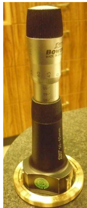
Obr. 2.12: Vnitřní dutinoměr Bowers [21], [1]
