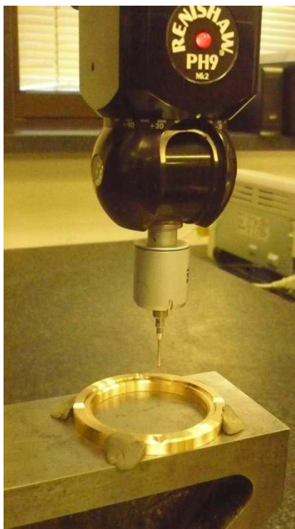
Obr. 2.13: Měření na souřadnicovém stroji Impact [1]
