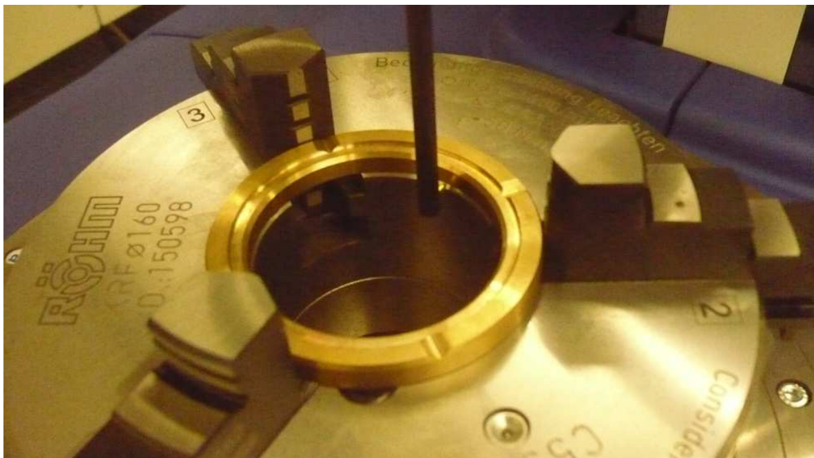
Obr. 4.8: Detail měření drsnosti povrchu u prvniho vzorku [26]
