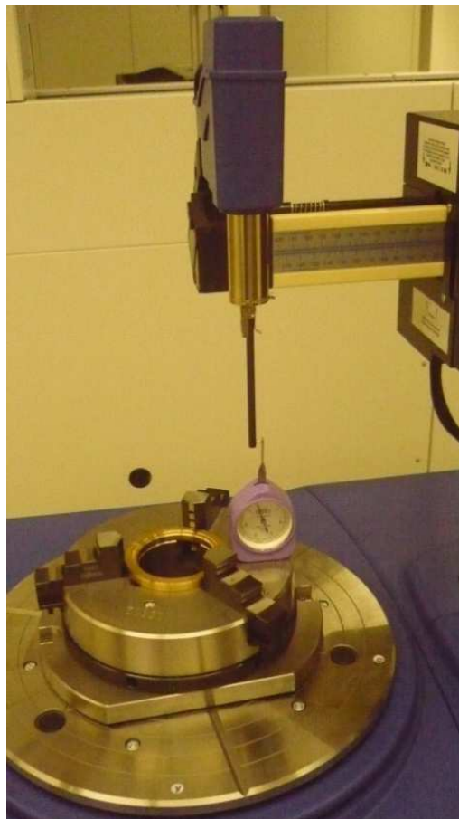
Obr. 4.7: Kontrola přitlačné síly hrotu [26]
