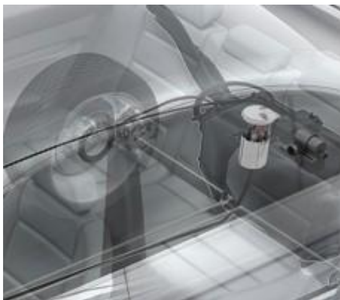
Obr. 1.2.2-1 Umístění nádržového modulu v automobilu – dle [11]
