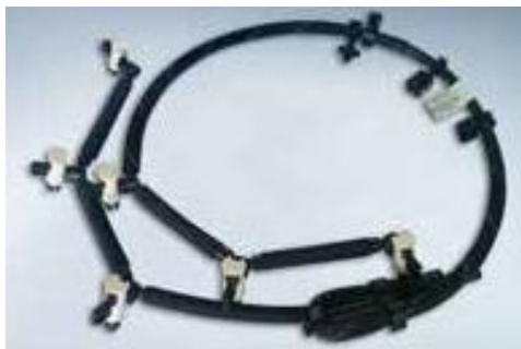
Obr. 1.2.1-6 Zpětné vedení paliva – dle [12]
