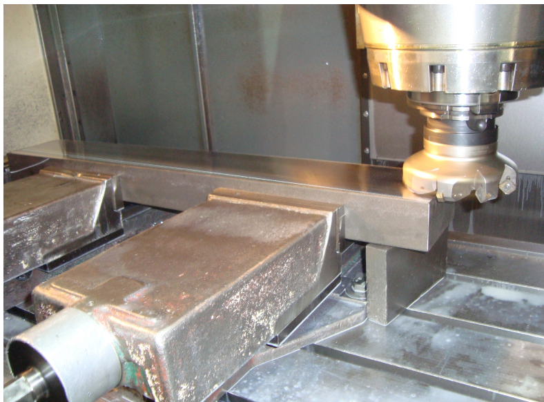
Obrázek 3.46: Frézovací hlavička \varnothing 125 mm
