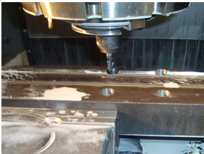
Obrázek 3.55: Hladicí fréza \varnothing 10 mm
