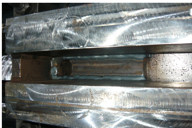
Obrázek 3.28: Svar uvnitř "hlavy"
