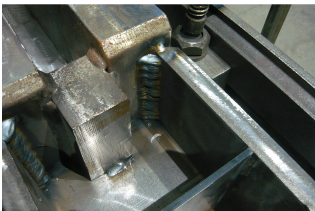
Obrázek 3.26: Svar mezi "tunelem" a "hlavou"
