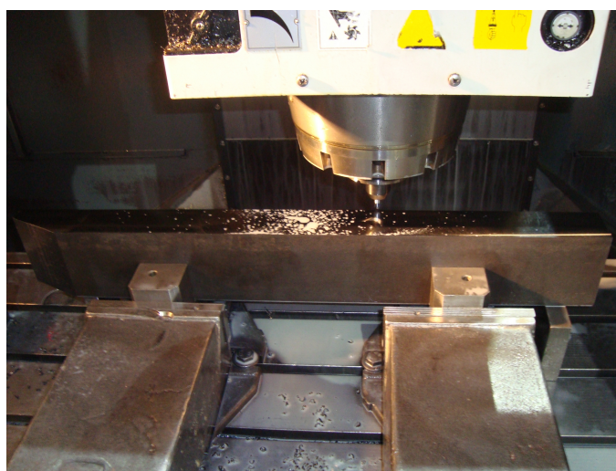
Obrázek 3.49: Srážecí fréza \varnothing 8 mm
