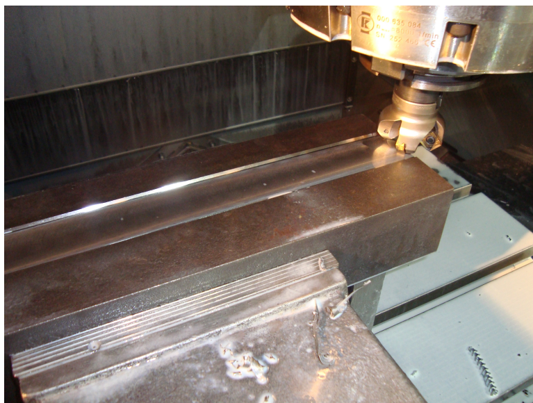
Obrázek 3.53: Frézovací hlavička \varnothing 40 \text{ mm}/45^\circ
