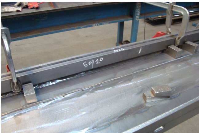
Obrázek 3.20: Podložení hranolu 50 × 20 mm zbroušenými kostičkami
