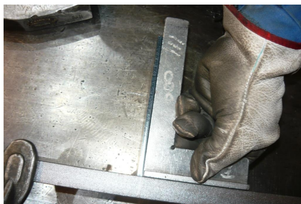
Obrázek 3.16: Kontrola kolmosti k hranolu 50 × 20 mm
