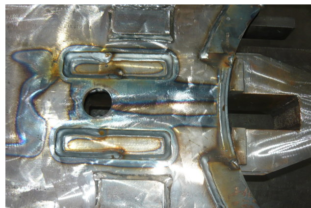
Obr \acute{a} zek 3.32: Zavaření pozic 14, 15, 18 a 19
