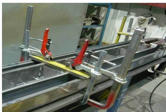
Obrázek 3.25: Přitážená vana ke stolu a přitážený „tunel“
