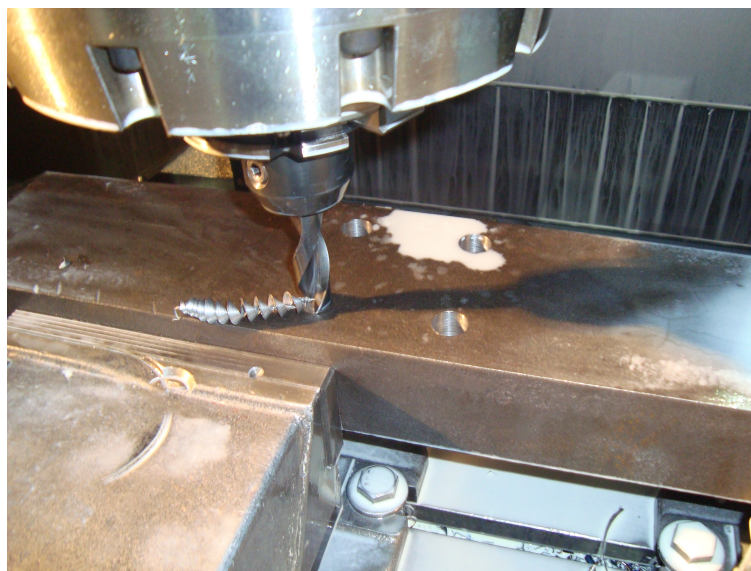
Obrázek 3.50: Vrták \varnothing 18 mm
