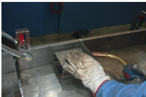
Obrázek 3.15: Bodování žebra s pomocnou kostkou
