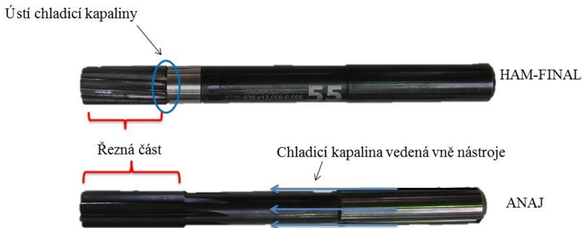
Obr. 48 Způsob chlazení SK výstružníků a cermetového výstružníku HAM-FINAL
