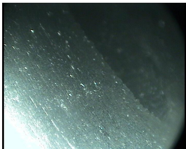
Obr. 44 Fotografický snímek povrchu obrobku vystruženého z cermetu.
