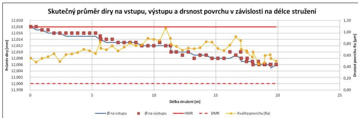
Graf 25 Průběh parametrů drsnosti (Ra) a průměru na vstupu a výstupu při vystružování výstružníkem z cermetu
