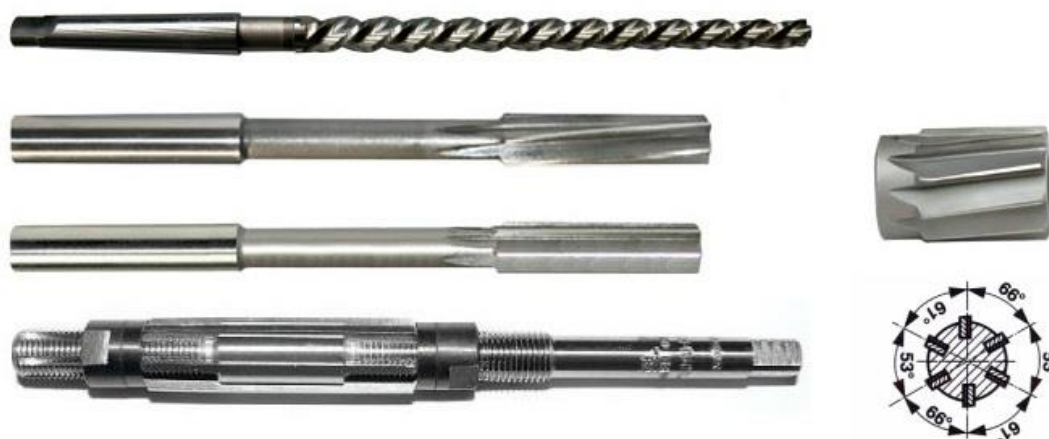
Obr. 8 Výběr z nabídky výstružníků z rychlořezné oceli firmy STIMZET (shora: Strojní výstružník s kuželovou stopkou na díry pro kolíky s kuželovostí 1:50 HSS 8-14mm; Výstružník strojní s přímými zuby s kuželovou stopkou HSS 6-32mm; Výstružník strojní se zuby ve šroubovici s válcovou stopkou HSSCo Cobalt 5%; Výstružník strojní s přímými zuby s válcovou stopkou HSSCo Cobalt 5%; Ruční výstružníky stavitelné bez vodícího pouzdra s nestejnou roztečí 7,6-60mm; vpravo: Výstružník nástrčný se zuby ve šroubovici - HSS 25-100mm) [18]
