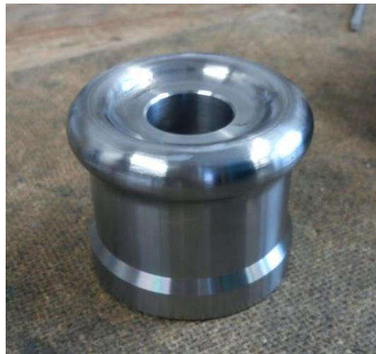
Obrázek 16 Model navržené frézy, polotovar frézy po soustružení
