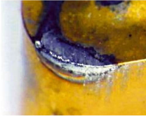
Obrázek 8 Plastická deformace řezné hrany [15]
