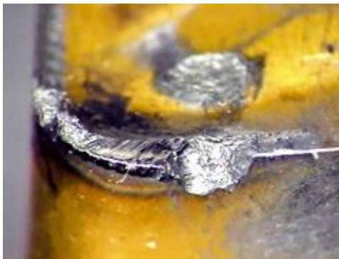
Obrázek 6 Vrub na hlavním ostří [15]
