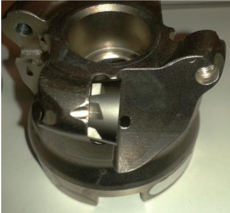
Obrázek 13 Nevhodné směřování kanálu pro přívod TK na čelo VBD - běžně používaný nástroj
