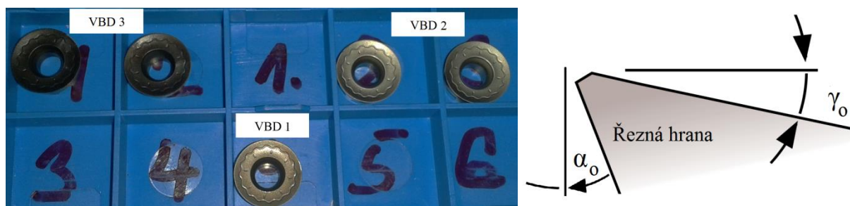
Obrázek 19 Fotografie použitých VBD, tvar jejich řezné hrany
