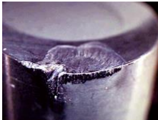
Obrázek 9 Opotřebení - odloupení části břitu [15]
