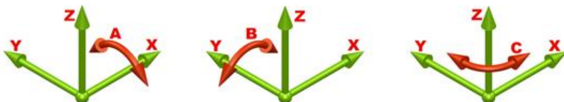
Obr.1.8 Schéma a značení lineárních a rotačních os [11]
