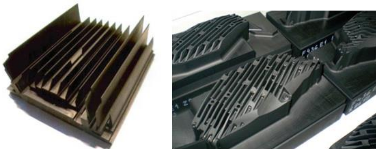
Obr.1.15 Příklady grafitových elektrod pro výrobu složitějších tvarů forem [19]
