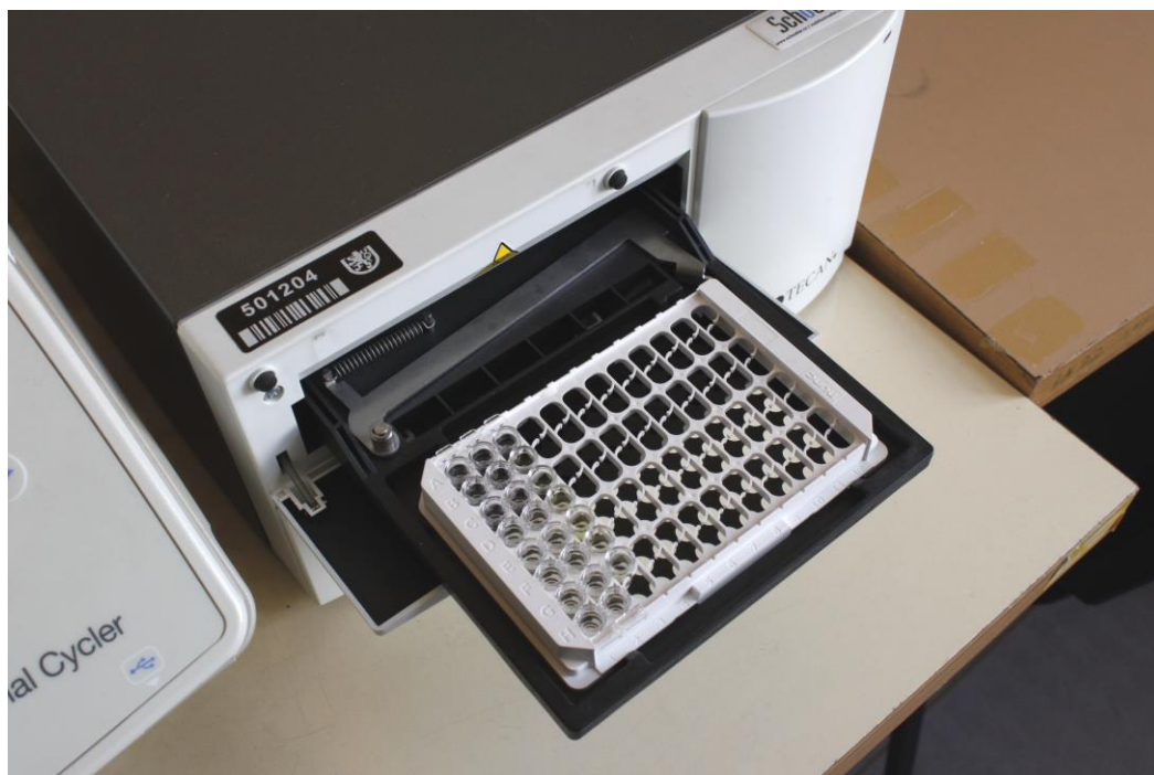
Obr. 5. Příklad přístroje na měření absorbance výsledných reakcí na mikrotitračních destičkách - ELISA reader VERSAmax™ (Molecular Devices).
