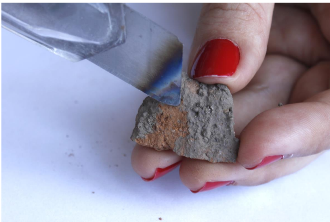
Obr. 1 Odběr vzorku keramiky pro analýzu
