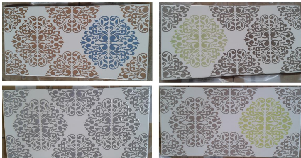
Obrázek 74: Zkoušky sítotisku na obklad (→více viz Příložené CD) 80
