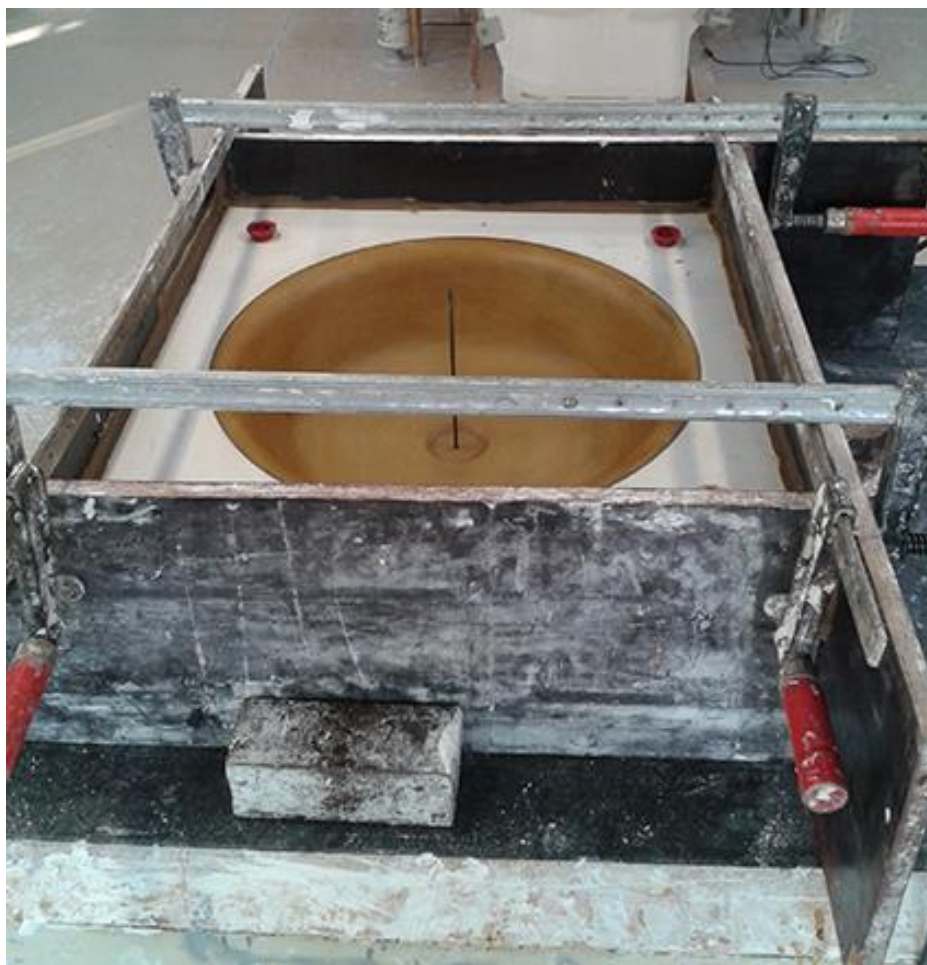
Obrázek 52: Výroba sádrové formy 58
