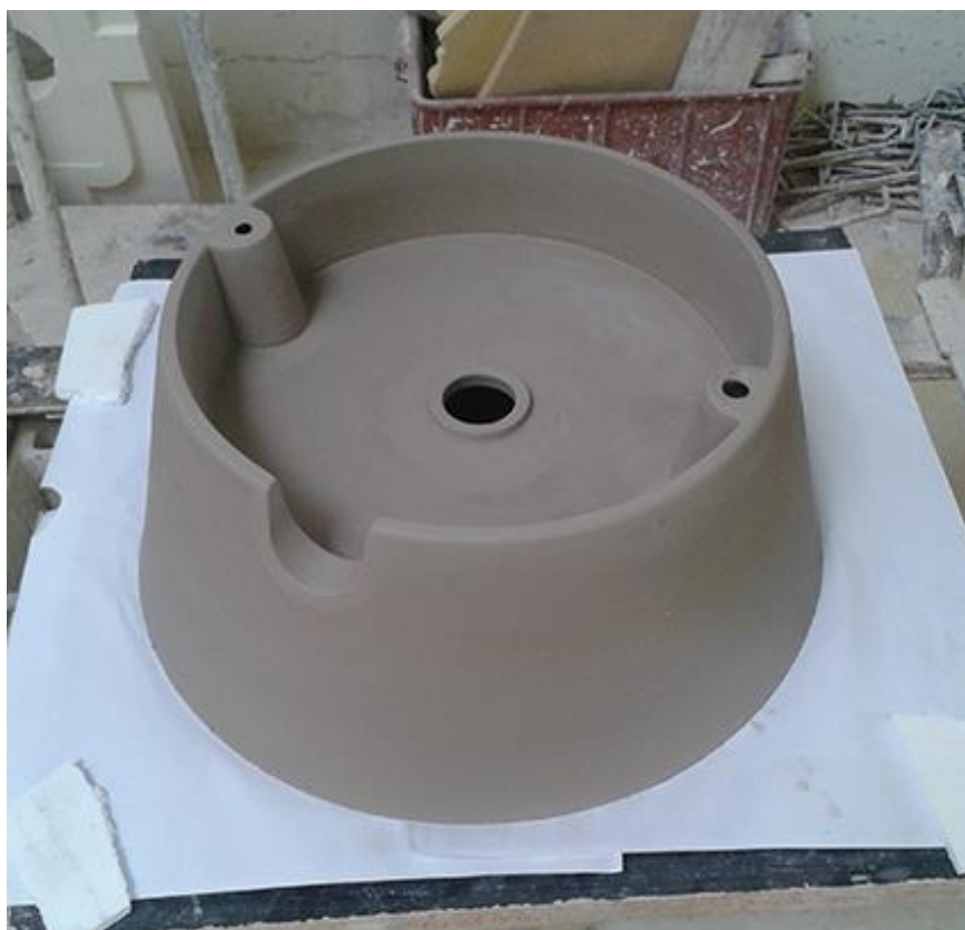
Obrázek 58: Vyklopený vylitek z formy – volně stojící umyvadlo 64
