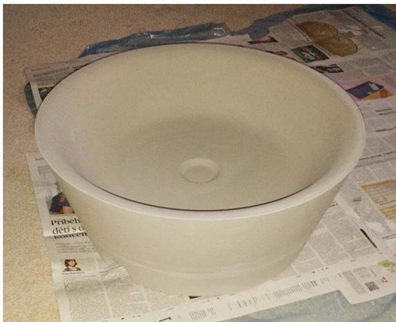
Obrázek 50: Vyfrézovaný model z tvrzeého polyuretanu 56
