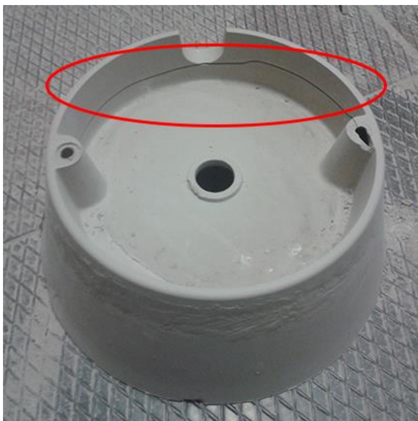
Obrázek 60: Prasklina na suchém výrobku vzniklá příliš rychlým sušením 66
