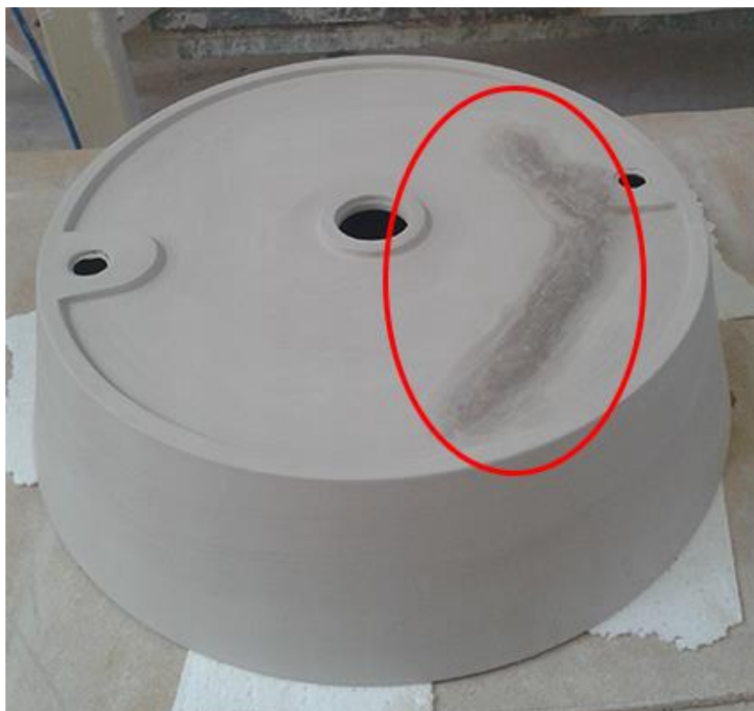
Obrázek 61: Oprava vzniklé praskliny směsí keramické šliky a šamotu 67
