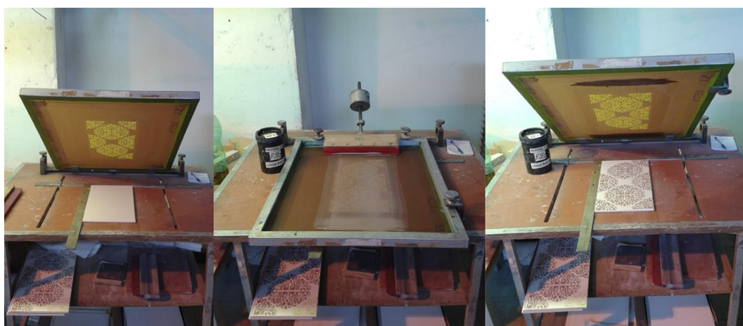
Obrázek 73: Výroba sítotisku na obklad (→více viz Příložené CD) 79
