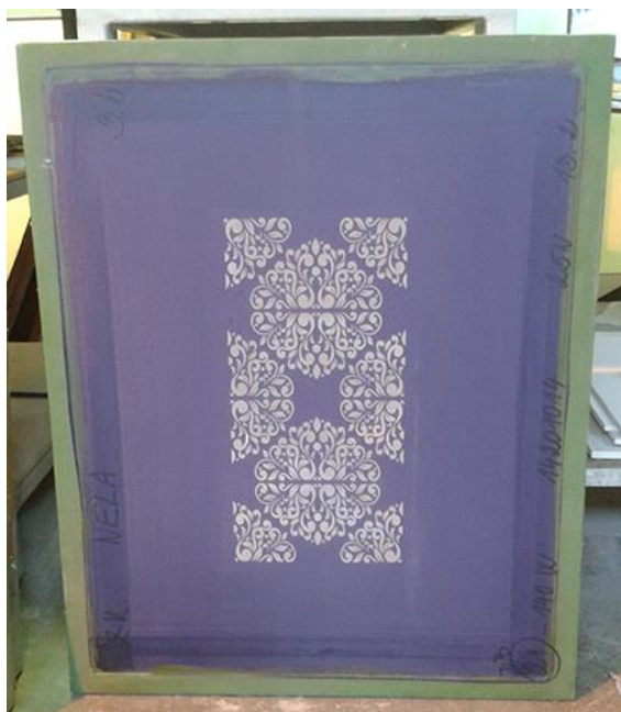
Obrázek 72: Síto pro posyp sklem 78
