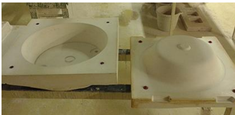
Obrázek 55: Forma pro nízká variantu umyvadla - příprava před litím 61
