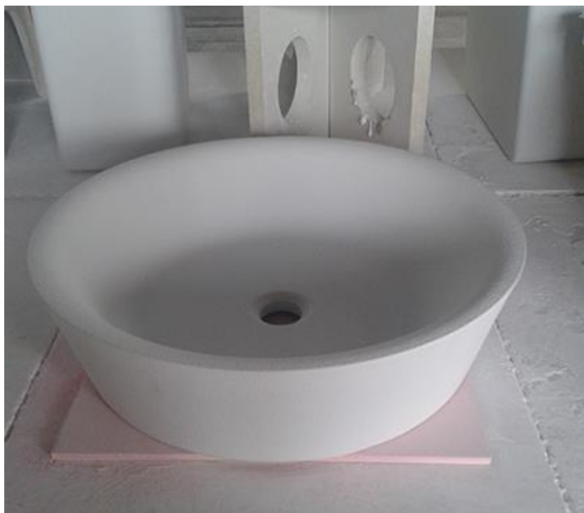
Obrázek 59: Naglazované umyvadlo na pecním voze umístěné na pálicí podložce 65
