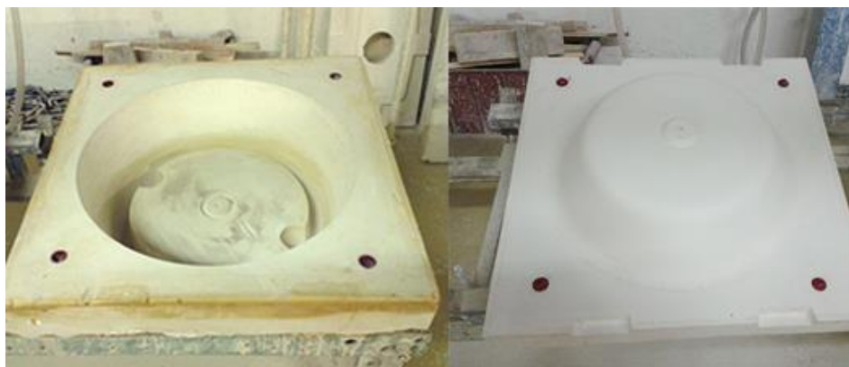
Obrázek 54: Forma pro vysokou variantu umyvadla - příprava před litím 60
