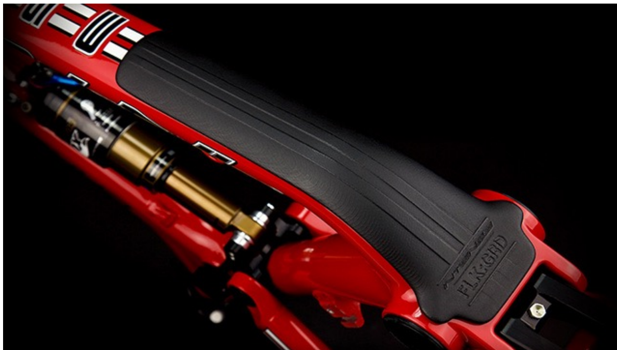
Ukázka klasického chrániče rámu - spodní rámové trubky 25
