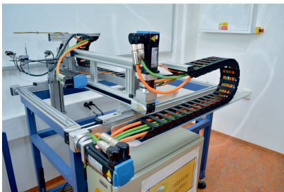
Obrázek 1: a) tří-osý robotický manipulátor, b) kompenzace tření na základě modelu
