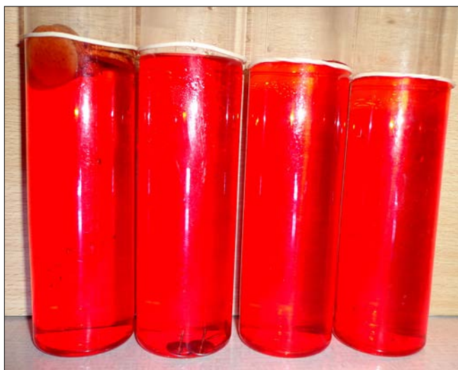
Obr. 6 – změny výšky hladiny pro různé varianty zadání; fotografie znázorňuje konečný stav po úplném roztátí ledu, gumičkou je vždy označena původní výška hladiny; zleva led s korkem, led s napínáčkou (obdoba olověné kuličky), samotný led a led s bublinou vzduchu; klesne pouze hladina vody v nádobě ledu s kovem
