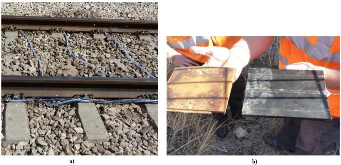
Obrázek 1.2.2-1 a) Uložení generátorů pod kolejemi b) Původní kovová destička a generátor [4]
