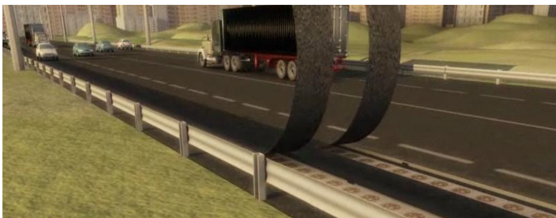
Obrázek 1.2.2-3 Uložení IPEG v silnici [4]
