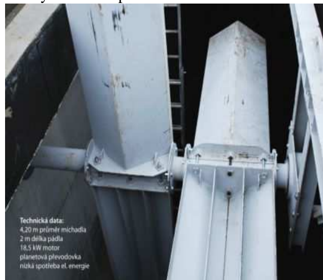
Obrázek 7: Vertikální lopatkové míchadlo [11]
