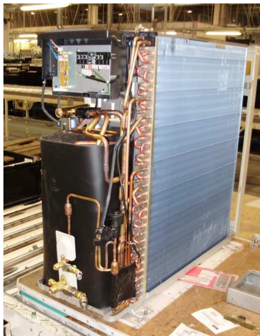
Obrázek 5-18: Jednotka GBS před montáží pravého plechu
