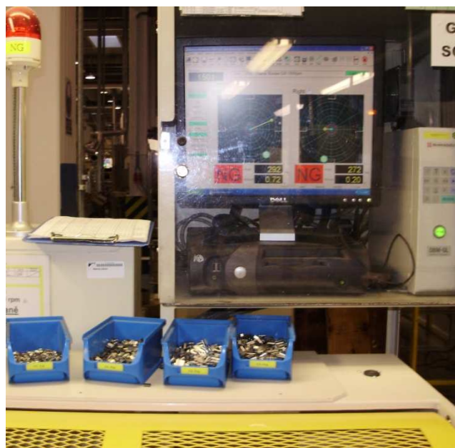
Obrázek 5-24: Monitor zobrazuje, že ventilátor je nutné dovážit, na levé straně o 0,72 g a na pravé straně o 0,20 g
