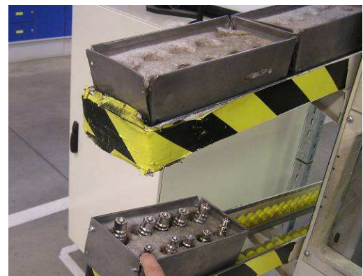
Obrázek 5-9: Výměna plné krabičky s kaplery za prázdnou
