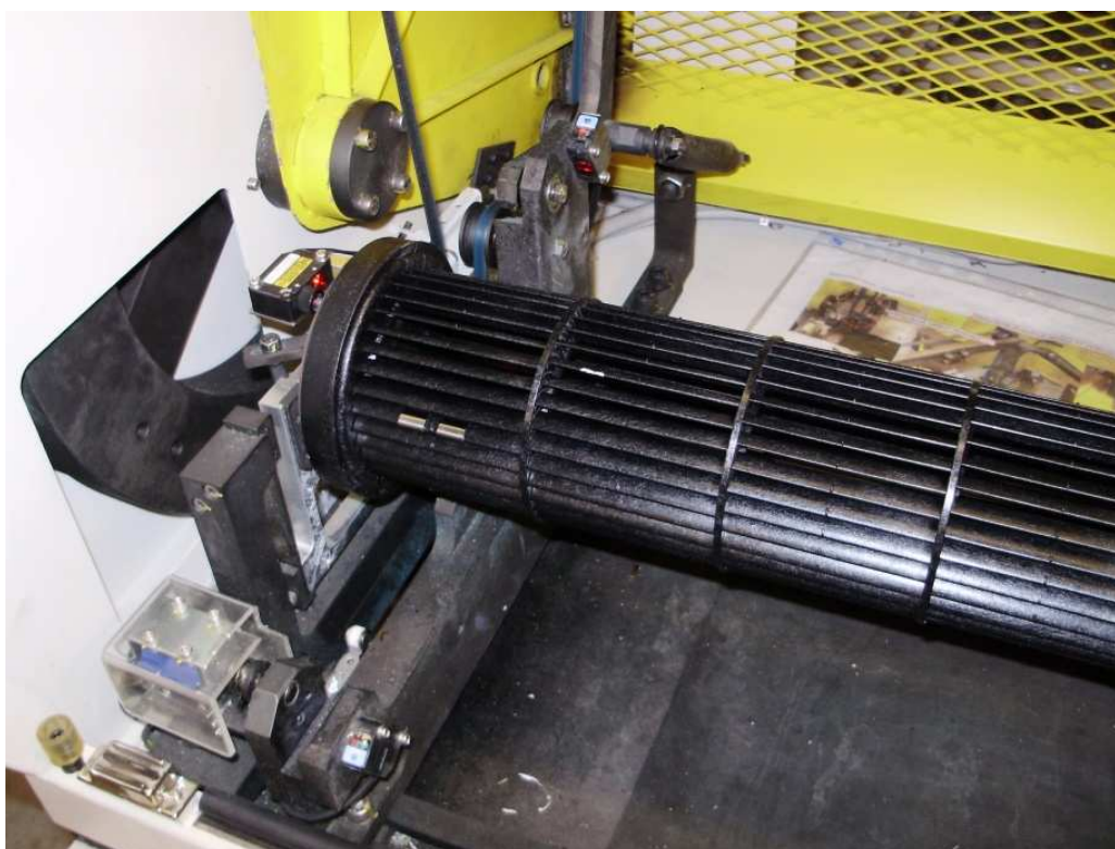
Obrázek 5-25: Závaží připevněná k žebru ventilátoru
