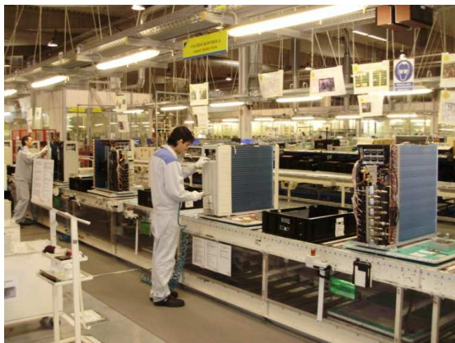
Obrázek 5-19: Montáž pravého plechu na jednotku GBS
