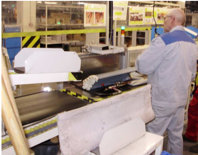
Obrázek 5-8: Pracoviště, na němž probíhá vypuštění směsi helia a dusíku z výměníku
