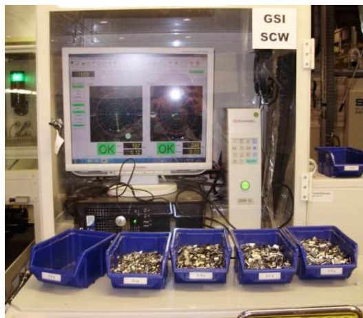
Obrázek 5-23: Monitor zobrazuje, že ventilátor je vyvážen
