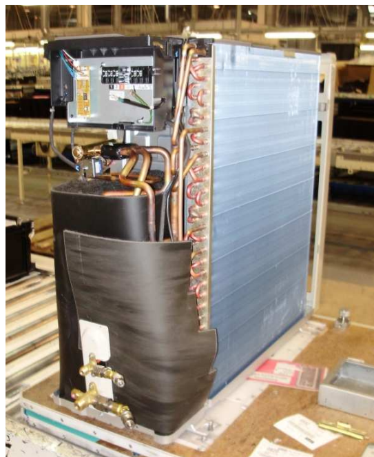
Obrázek 5-17: Jednotka GBS s nasazenou protihlukovou izolací
