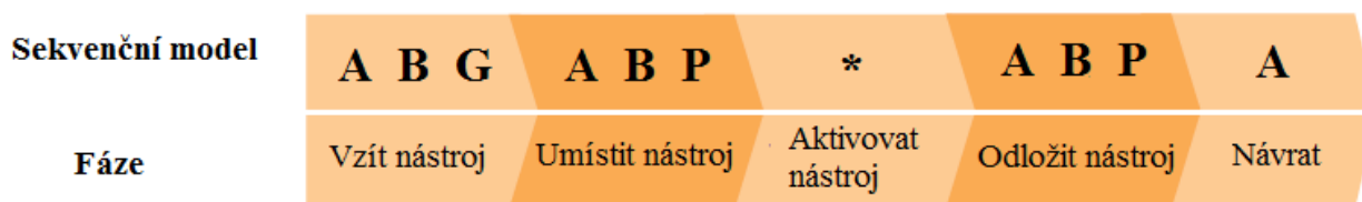
Obrázek 4-9: Sekvenční model pro použití nástrojů
