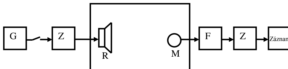
Obrázek 8 Blokové schéma pro měření doby dozvuku
