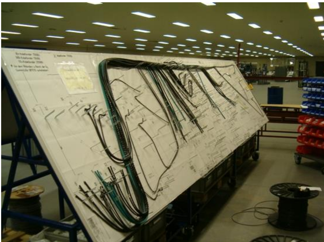
Obr. 3.2 Výroba kabelového svazku
