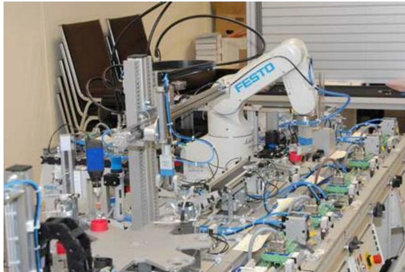
Obr. 3.5 Testovací stůl pro kabelové svazky
