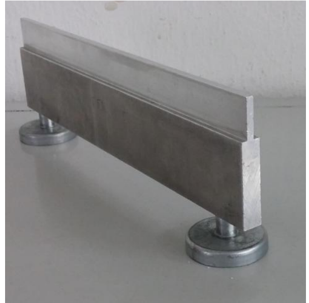
Obr. 1.17 Lišta jako podpora panelu DPS
