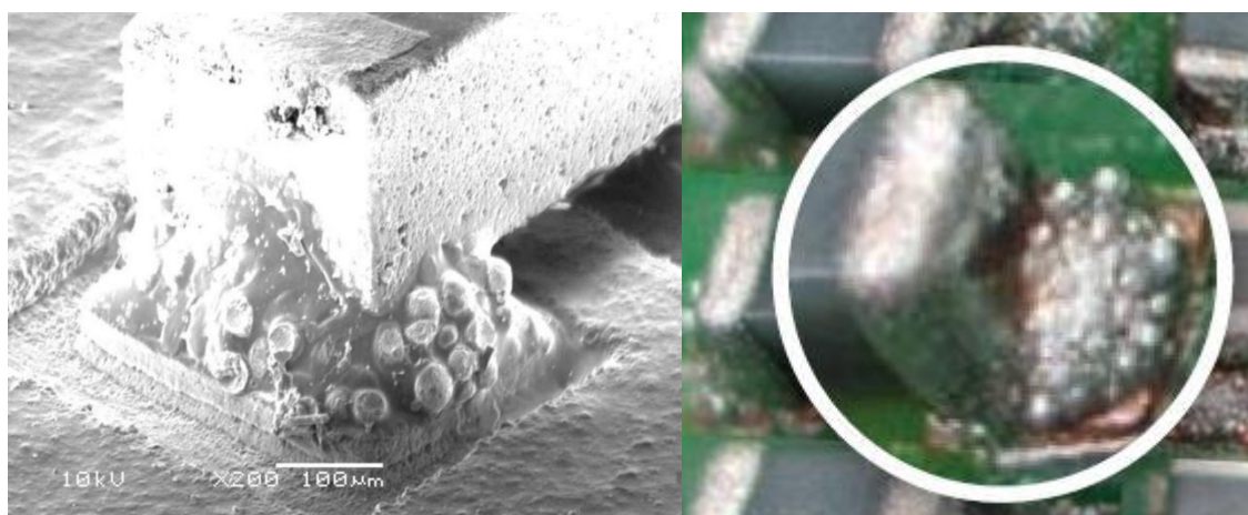
Obr. 3.14 Příklady defektu solder graping – převzato z [29, 30]
