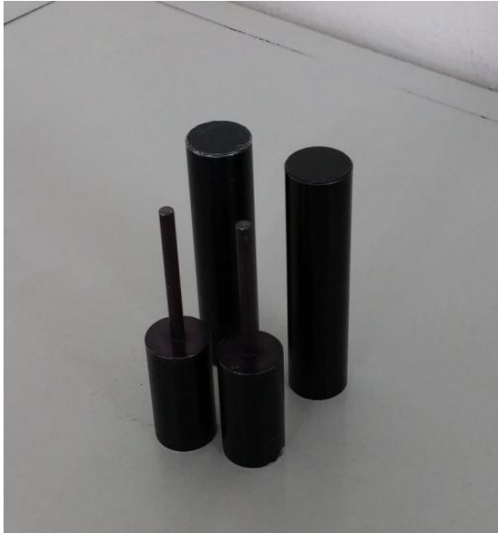
Obr. 1.16 Piny jako podpora panelu DPS
