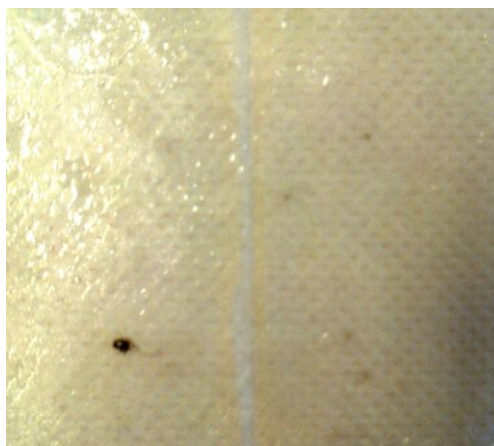
Obr. 4.20 Testovací vzorek po měření elektrické pevnosti
