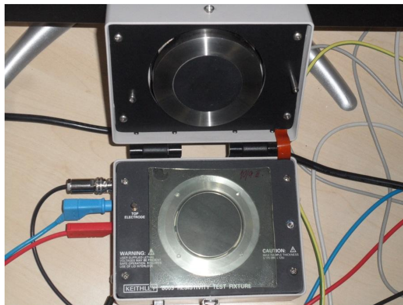
Obr. 4.2 Použitý měřicí systém pro měření absorpčních charakteristik
