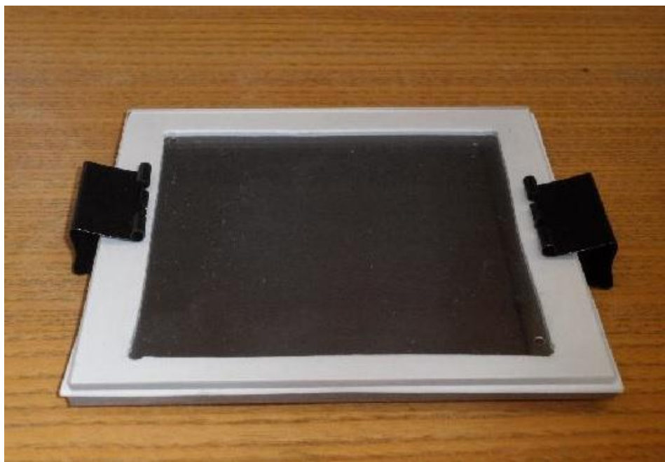
Obr 3.1 Forma na vytvrzování - fotografie
