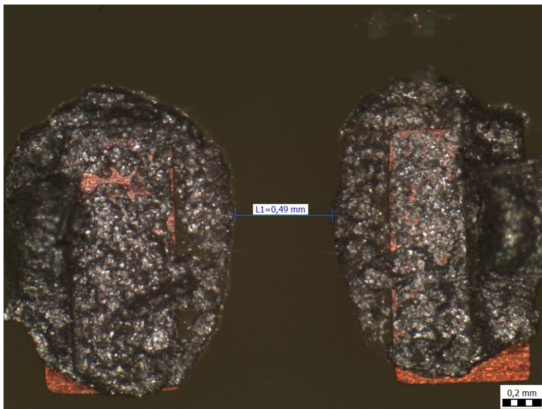
Obr.5.5 Ukázka měření izolační vzdálenosti
