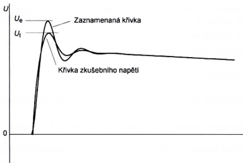
Obr. 5: Časový průběh zaznamenané křivky a křivky zkušebního napětí (převzato z [4])
