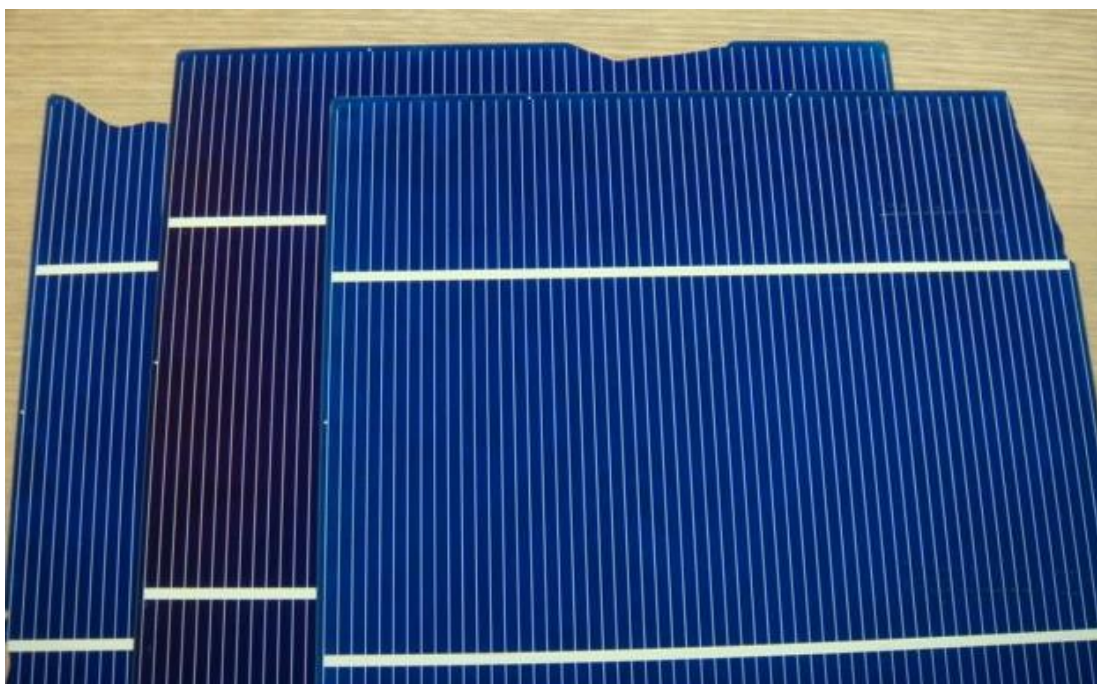
Obr. 3.1 Mechanicky poškozené články [42]
