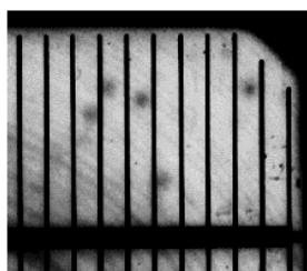
Obr. 3.7 Nečistoty vzniklé při výrobě [45]
