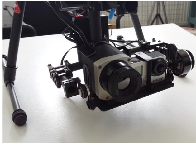
Obr. 4.14 Termokamera Optris PI 450 na bezpilotním letounu TELINK GRID 720 [64]
