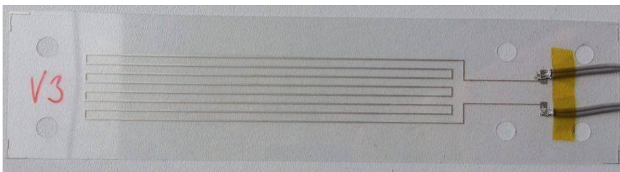
Obr. 3.3 Vzorek s vodivou cestou o tloušťce 0,4 mm na PEN substrátu.
