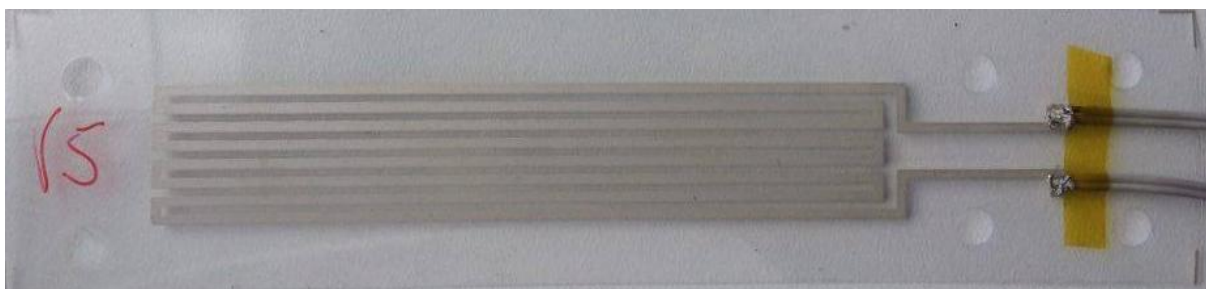
Obr. 3.4 Vzorek s vodivou cestou o tloušťce 1,5 mm na PEN substrátu.
