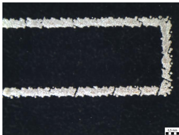
Obr. 3.22b Trhliny ve vodivé cestě způsobující selhání vzorku.
