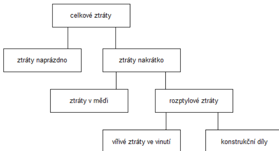
Obr. 1.4 Ztráty v transformátoru, které způsobují oteplení [6]
