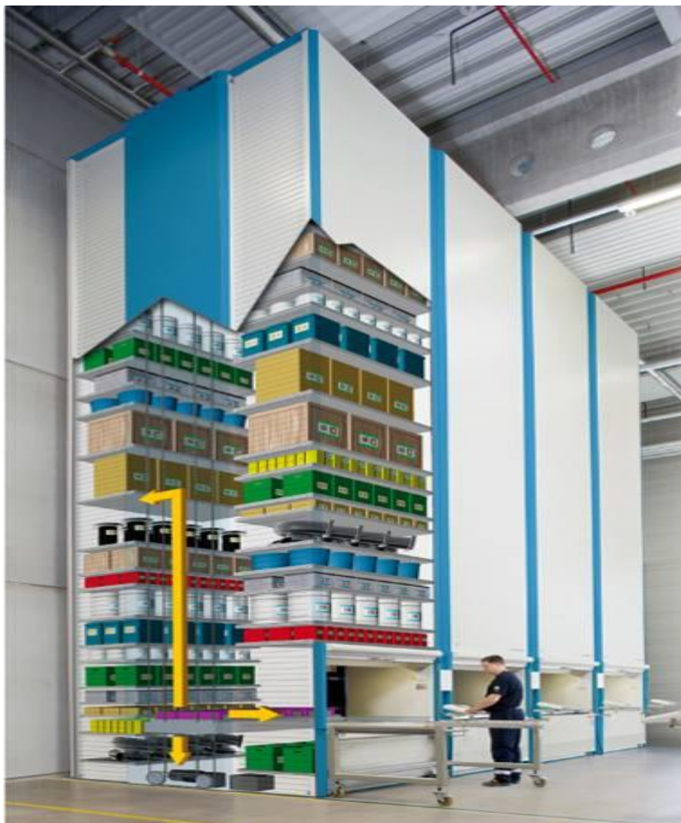
Obrázek 3: Skladový systém Lean lift [Zdroj: MURR]
