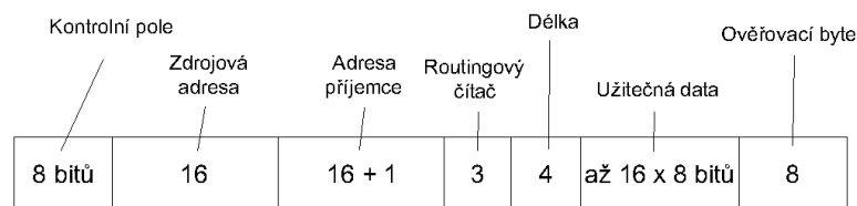
Obr. 2.4 Struktura telegramu TP 1 (převzato z [2])
