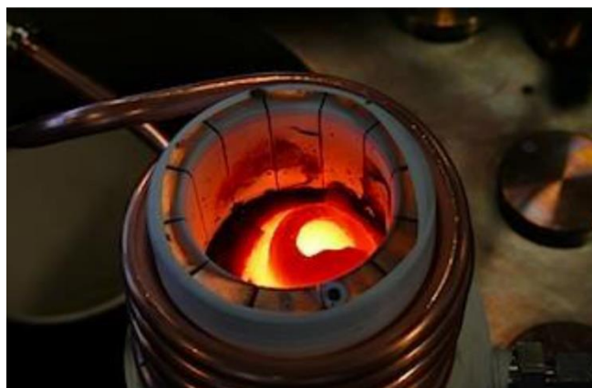
Obr. 4.2 Ukázka tavení v segmentovém kelímku [Převzato z [27]]
