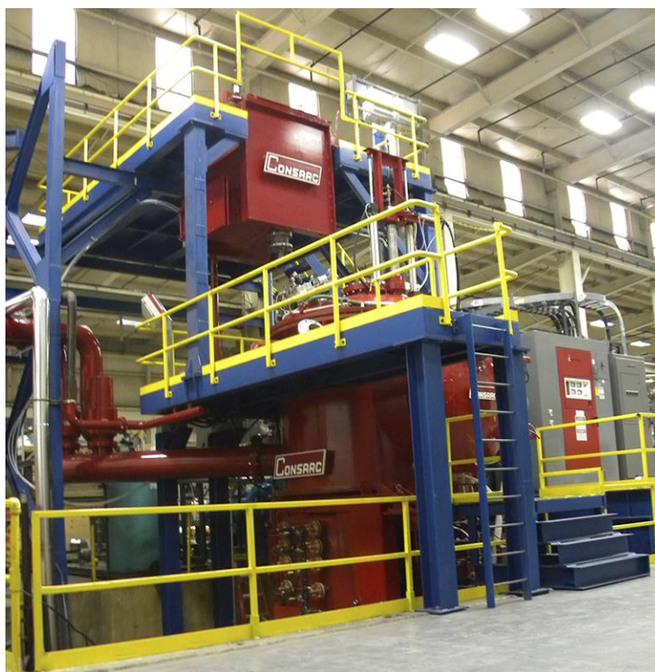
Obr. 4.4 Ukázka studeného kelímku pro průmysl od firmy Consarc [Převzato z [34]]
