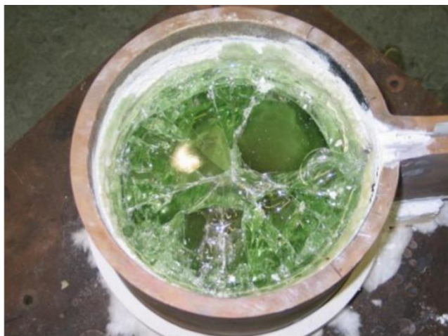
Obr. 4.3 Ukázka tavení skla v kelímku s integrovaným induktorem [Převzato z [28]]
