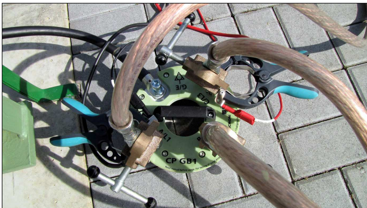
Obrázek 10. CP GB1 Propojení vodičů se svorníky zemnicí jednotky
