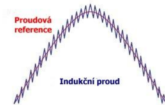
Obr. 12 Průběh indukčního proudu při režimu CCM průměrný indukční proud [3]
