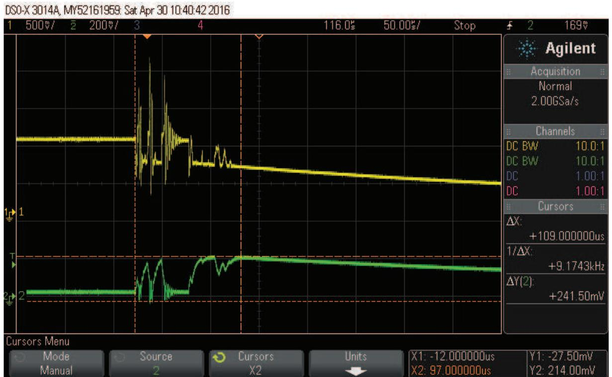
Obr. 44: Průběh proudu a napětí sepnutí reléového spínače
