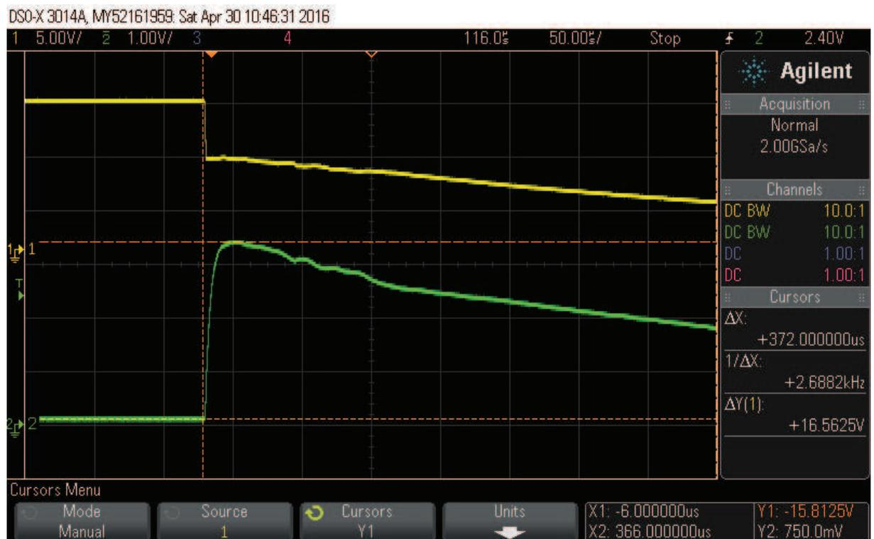
Obr. 45: Průběh proudu a napětí sepnutí polovodičového spínače
