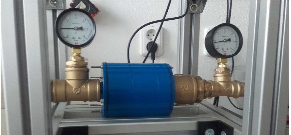
Obrázek 5.5 – Fotografie z měření tlakové ztráty
