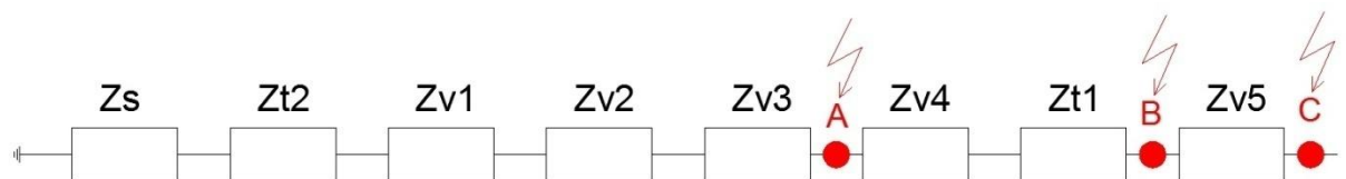
Obr. 5.4 Náhradní schéma elektrické sítě pro řešení zkratových poměrů
