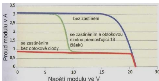
Obr. 2.8 VA charakteristika PV panelu s použitím a bez použití obtokové diody [3]
