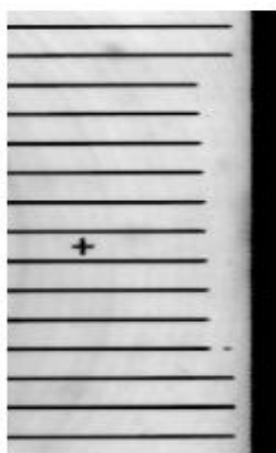
Obr. 9 – Ukázka chyby sítotisku na článku
