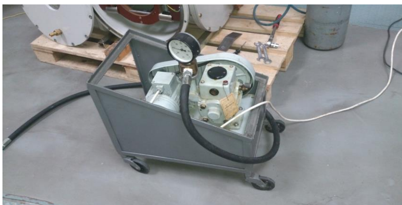
Obr. 6.1 Tlaková vývěva na odčerpání plynu z tlakové nádoby
